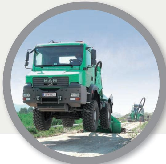
Links: Der Verlegepflug wird mit einer Stahlseilwinde von einem Spezialunimog gezogen. Dieser kann eine Zugkraft von bis zu 250 t aufbringen.
