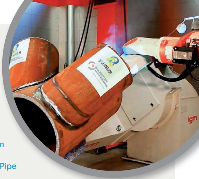
Um mit Jacketstrukturen weiterhin gegenüber Monopiles wettbewerbsfähig zu bleiben, ist ein Wandel von der manuellen Fertigung hin zur industriellen Serienproduktion erforderlich. HFI-geschweißte Stahlrohre von Salzgitter Mannesmann Line Pipe sind mit Längen von bis zu 18 Metern prädestiniert dafür.
