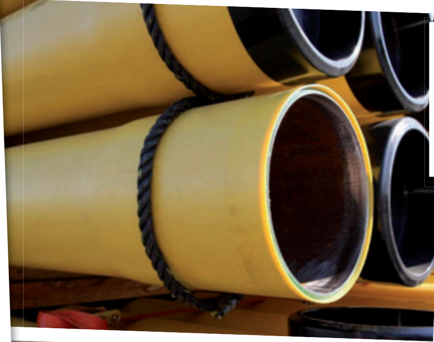
Links: Die Muffenenden der HDPE-umhüllten Zap-Lok®-Rohre wurden mit einer ca. 10 mm langen Überlappung des Kunststoffes und einem Korrosionsschutz der Stahlrohlfase versehen. Die schwarzen Kunststoffkappen dienen zum Schutz vor Beschädigungen. Oben: Verladung der fertigen Rohre im Hafen Antwerpen.
