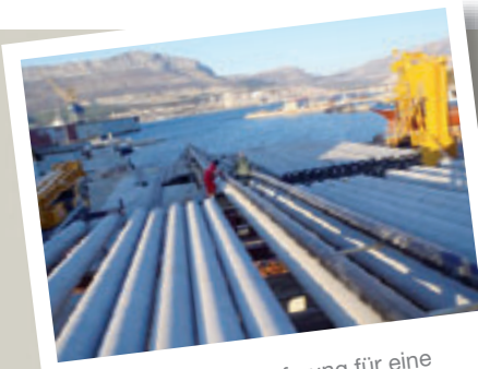
1. Kroatien Rohrlieferung für eine Trinkwasserleitung zwischen den kroatischen Inseln Brac und Hvar.
