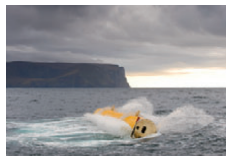
Der Wellenkonverter »Oyster« pumpt Meerwasser an Land, um eine Turbine zur Stromerzeugung anzutreiben
