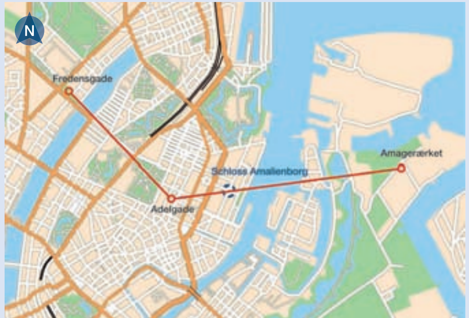
Die Verlegetrasse führt in bis zu 40 m Tiefe von der vorgelagerten Amager-Halbinsel unterhalb des Schlosses Amalienborg zum Tunnelschacht »Adelgade« und von dort zum Zielschacht »Fredensgade«
