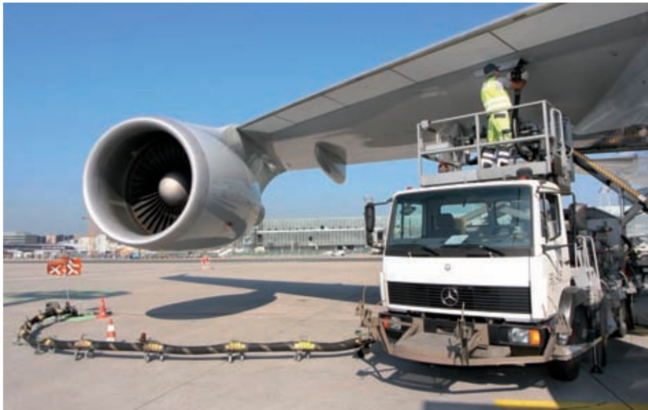
Links: Der Frankfurter Flughafen zählt zu einem der wichtigsten Luftverkehrsdrehkreuze der Welt Oben: Betankung eines Flugzeuges mit einem Dispenserfahrzeug
