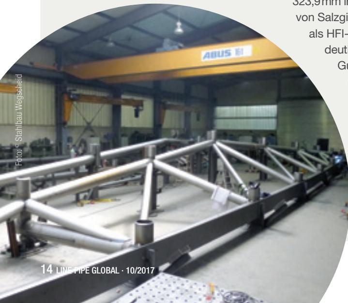
geliefert. Hier wurden die bereits exakt abgelängten Rohre zu Einzelteilen der Dachgerüste verschweißt und lackiert, die Anfang 2017 auf das Freigelände gegenüber der Baustelle in München transportiert wurden. Zwei Einzelteile ergeben zusammen je einen 60 Meter langen Dachträger, von denen 13 Stück pro Halle den freitragenden Dachstuhl bilden. Das Richtfest ist für den 20. Juni 2017 geplant.
