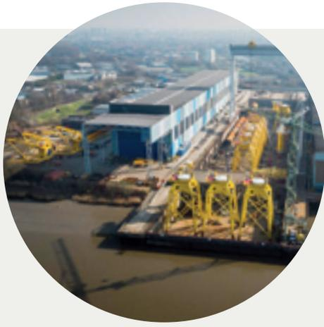
Smulders Projects erhielt den Auftrag zur Fertigung von 28 Gründungsstrukturen. Die gelieferten HFI-geschweißten Rohre kamen hier als J-Tubes zum Einsatz.
