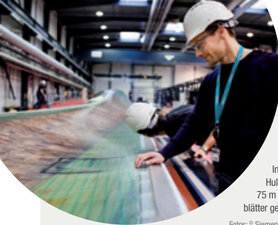
Im britischen Hull werden die 75 m langen Rotorblätter gefertigt.
